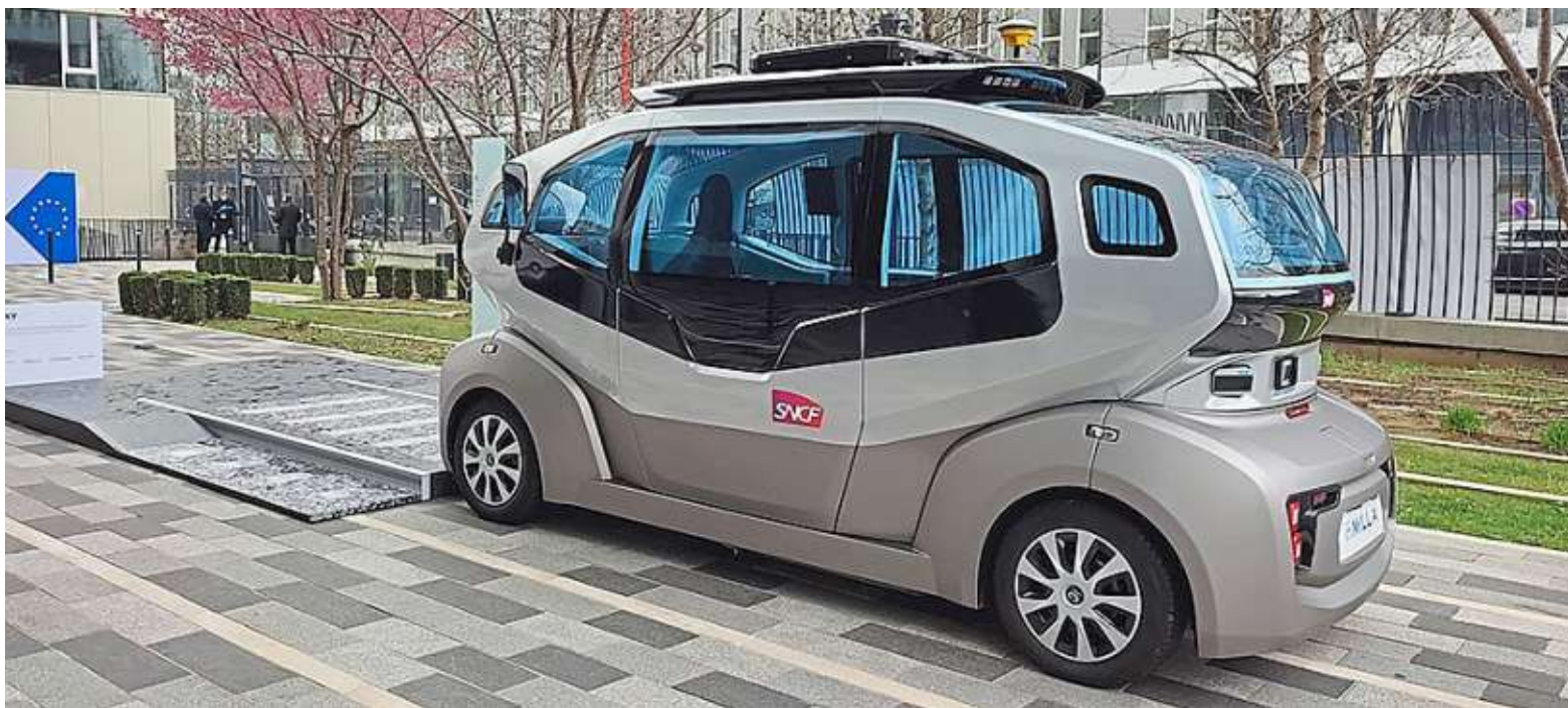
Flexy est un véhicule électrique de neuf places, pouvant rouler aussi bien sur la route que sur des rails. Des premiers essais devraient se tenir sur des tronçons pilotes dès 2024. SNCF
