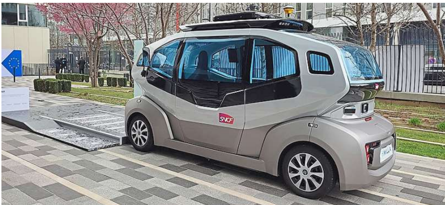
Flexy est un véhicule électrique de neuf places, pouvant rouler aussi bien sur la route que sur des rails. Des premiers essais devraient se tenir sur des tronçons pilotes dès 2024. SNCF
