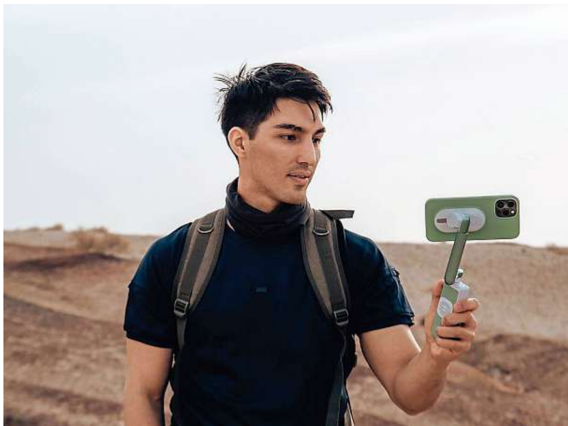
Le PowerVision S1, avec son stabilisateur motorisé sur trois axes, permet de filmer sans tremblements. Bonus, il fait office de batterie d'appoint. PowerVision
