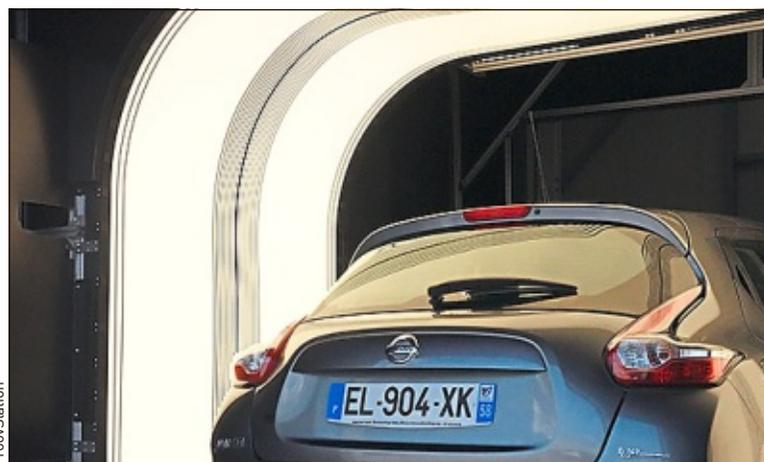
Le portique permet de passer au crible un véhicule en trois secondes.
