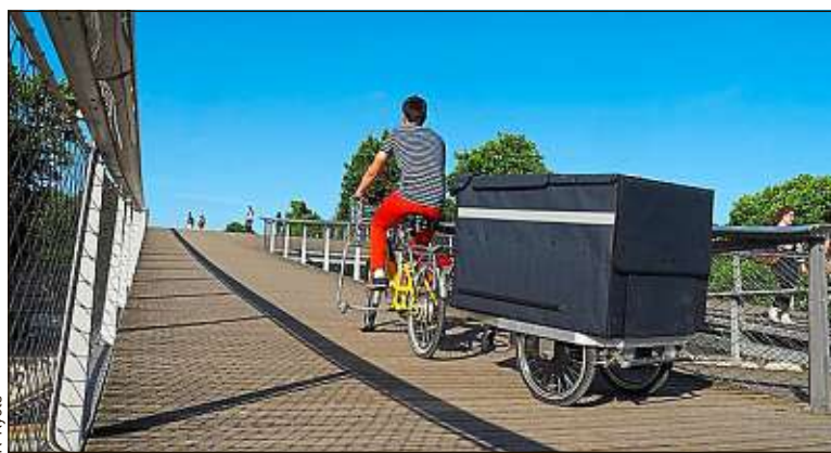
La K-Ryole, remorque autopropulsée, peut acheminer 250 kg de colis.
