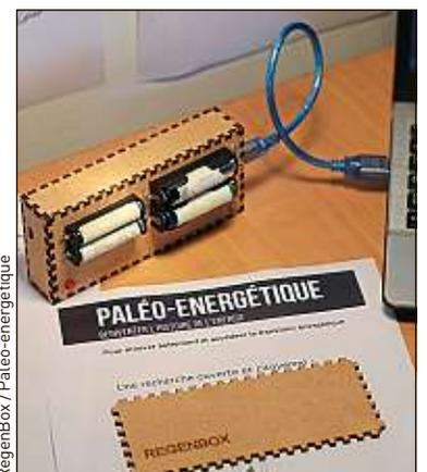
Le chargeur de piles jetables se connecte via USB à l'ordinateur.
