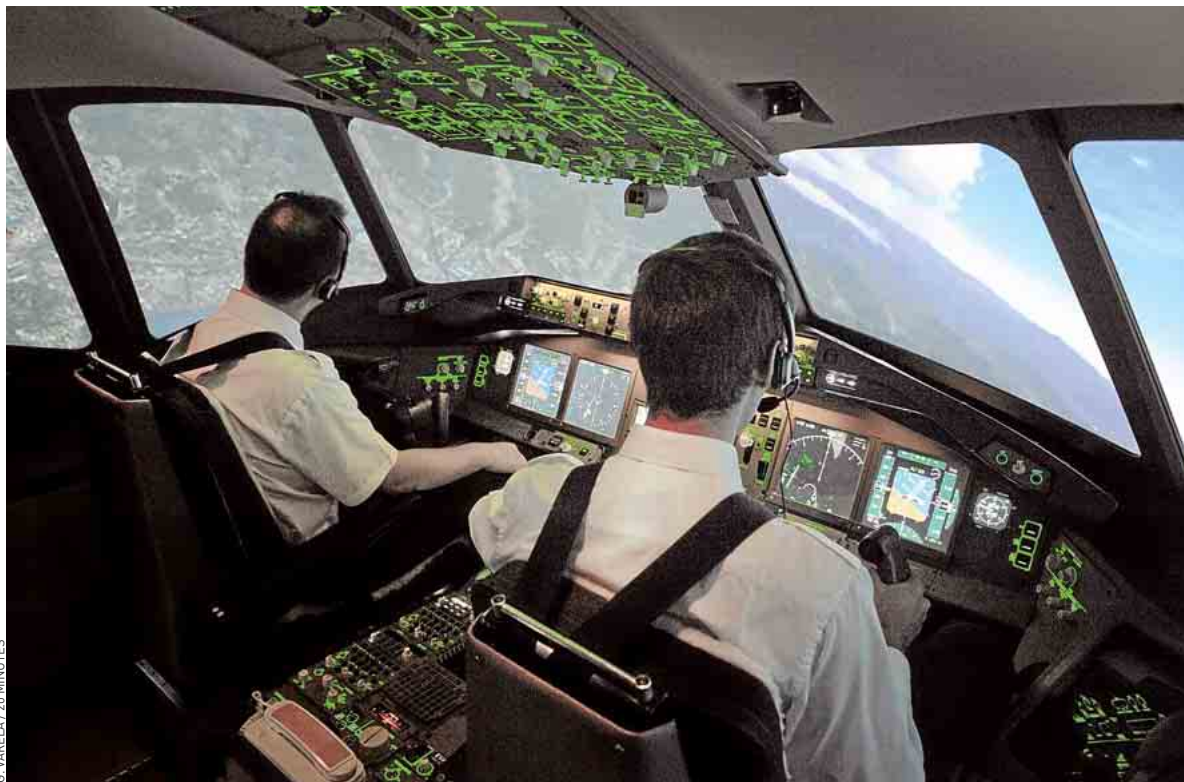
Le simulateur donne l'illusion d'un avion en vol par le biais d'images qui bougent et de capteurs dans les sièges.
