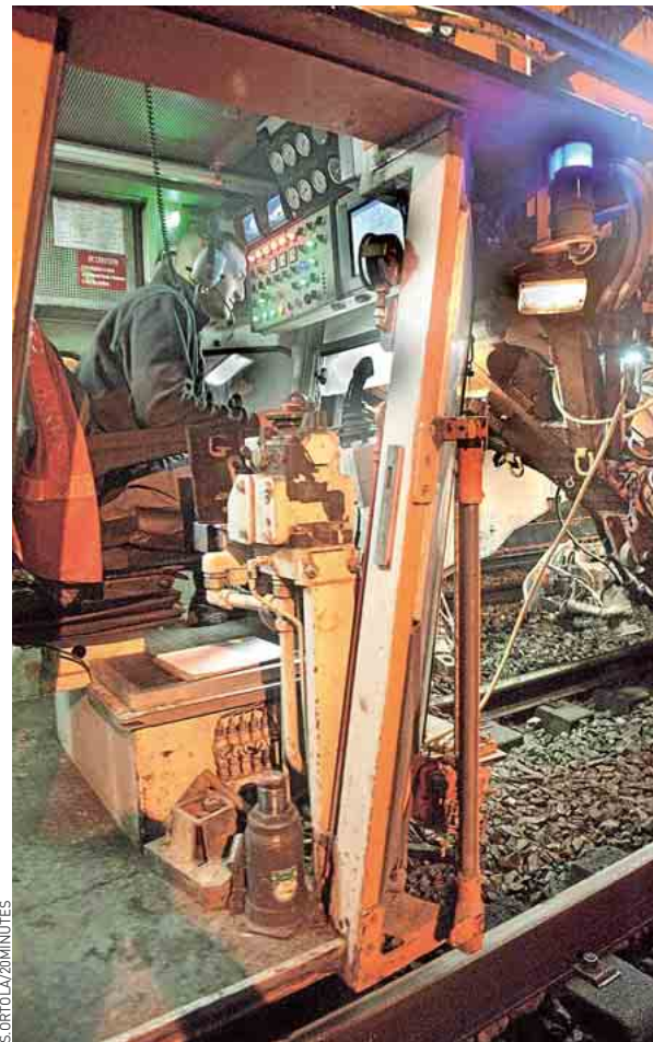
Les deux « trains de suite » de 700 mètres de long permettent le changement du ballast et le remplacement des rails.
