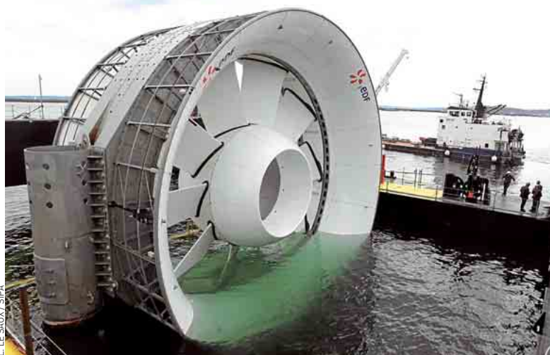
L'une des quatre hydroliennes du parc EDF construites par DCNS.
